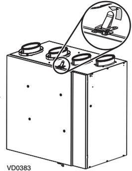
3. Glisser hors de l'appareil les deux filtres du dessus du noyau.
